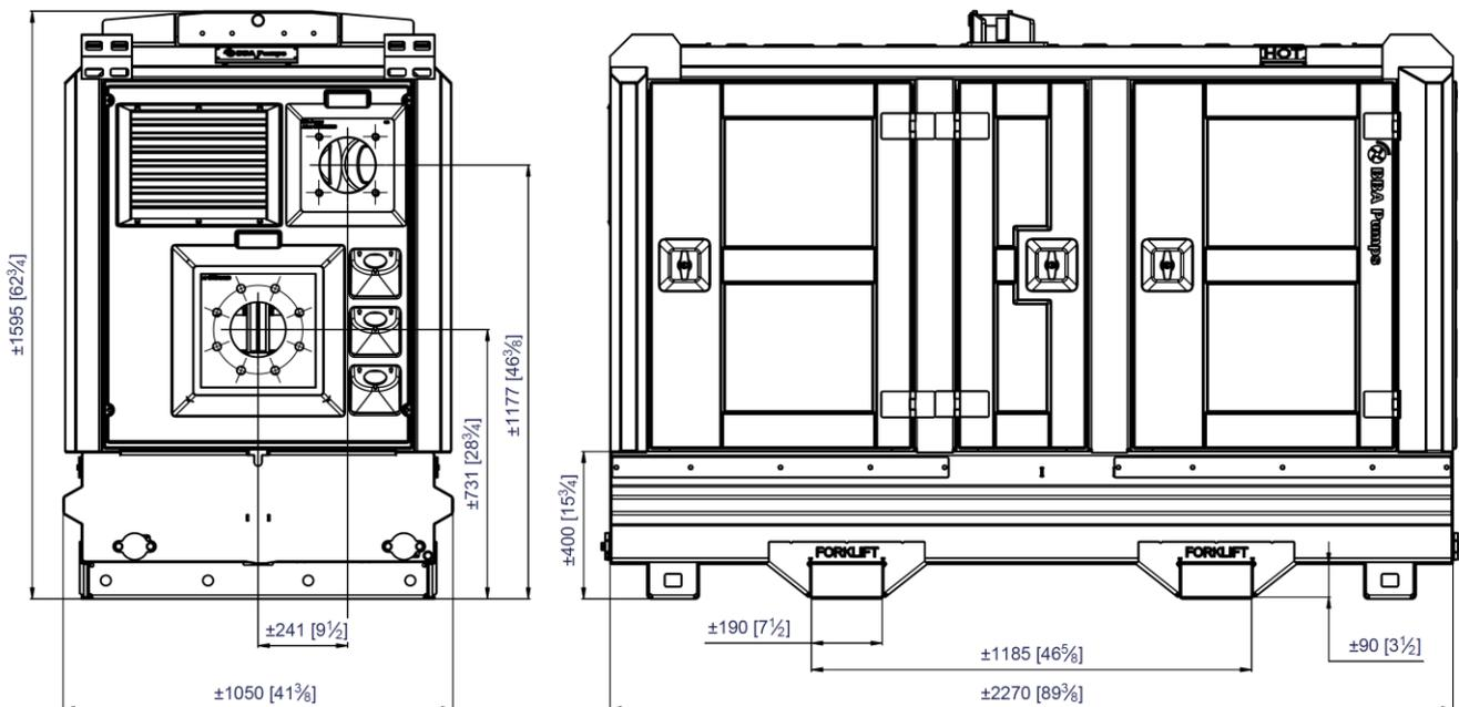
Les dimensions réelles (en mm) peuvent varier en fonction des raccords sélectionnés.
